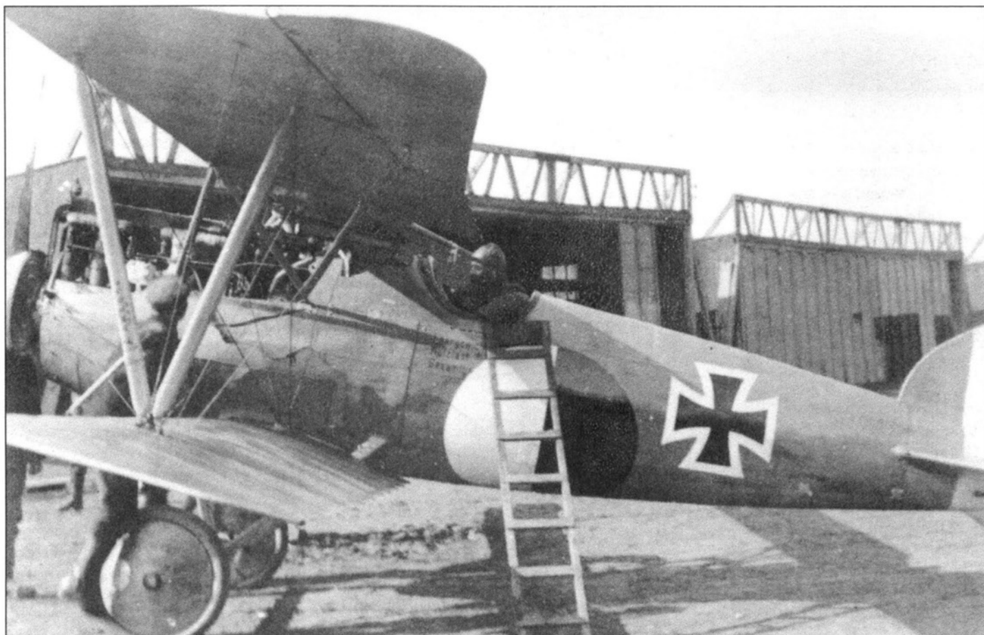
На этом «Альбатросе» D Va постройки ОАВ летал баварец Фрих Риттер фон Рёт в начале 1918 г., когда он служил в Jasta 23. Хорошо видна персональная эмблема «истребителя азростатов» - черно-белый круг, белая вертикальная полоса на хвостовом оперении видна частично. Поверхности крыла, горизонтального оперения и руля направления - лозинг. Большая часть фюзеляжа - неокрашенная фанера.
