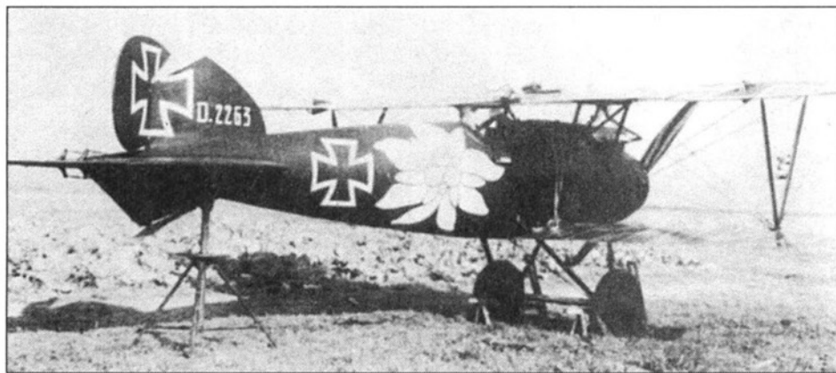
Отто Киссенберт также летал на «Альбатросе» D V (D.2263/17) с изображением цветка эдельвейса летом 1917 г., когда он командовал Jasta 23b. Самолет целиком окрашен в черный цвет, обратите внимание на заводской номер, написанный на киле аэроплана. Обшивка крыльев - лозинг. На подкосе бипланиной коробке установлен измеритель воздушной скорости типа анемометра.
